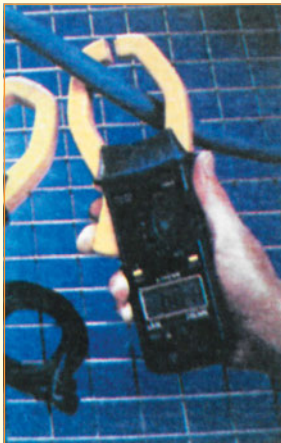
Εικόνα 2.19.γ Μετασχηματιστές εντάσεως.
